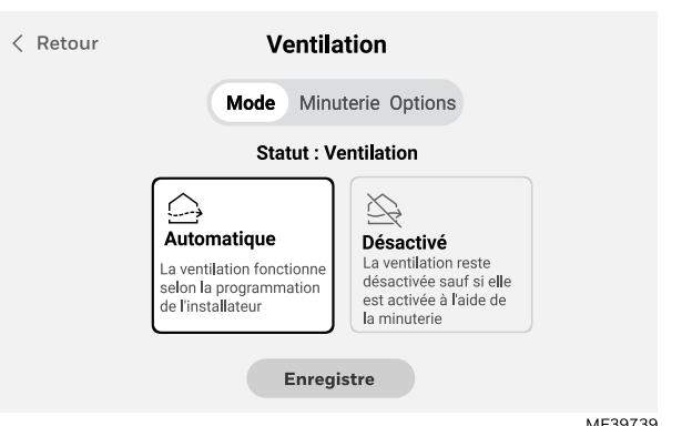
Si le thermostat a été réglé pour contrôler la qualité de l'air intérieur, des options permettant de contrôler l'humidité et/ou la ventilation seront disponibles. Ces paramètres peuvent être facilement réglés dans le menu utilisateur du thermostat ou dans l'application.
