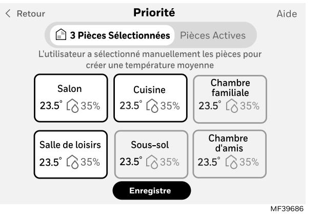
Donnez la priorité à différentes zones de votre maison en utilisant des capteurs d'intérieur sans fil compatibles. Vous pouvez sélectionner manuellement ces zones ou laisser les capteurs faire automatiquement lorsqu'une activité est détectée.
