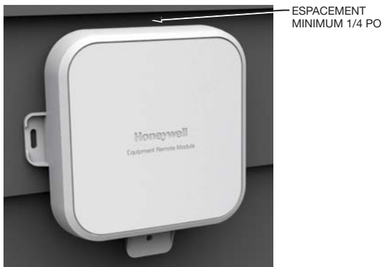
Fig. 12. Si le montage a lieu sur un bardage à clin, laisser suffisamment d'espace pour permettre le retrait du couvercle.
