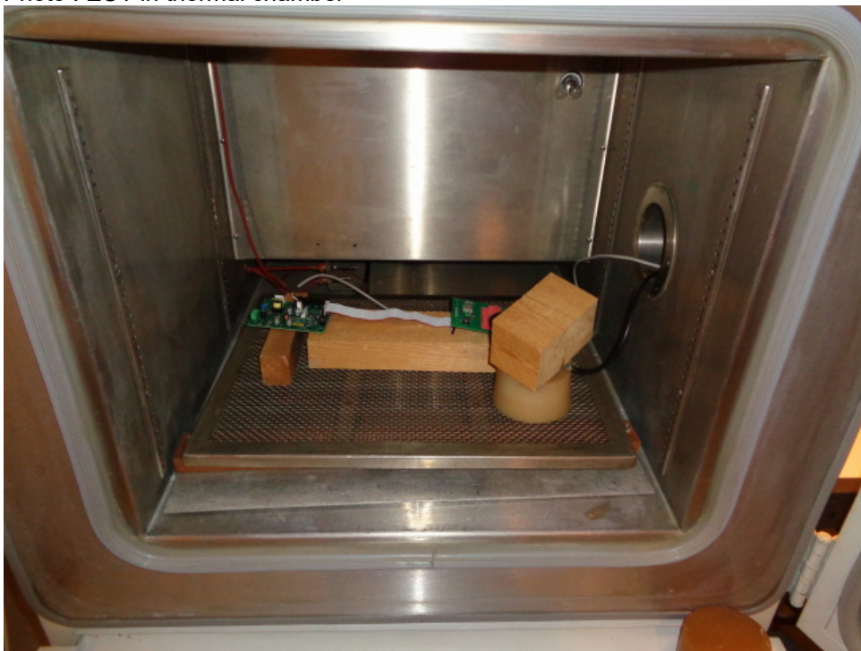
Photo : EUT in thermal chamber
