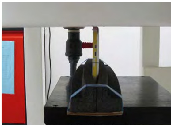
Fig.5 EUT Edge 3 to flat phantom
