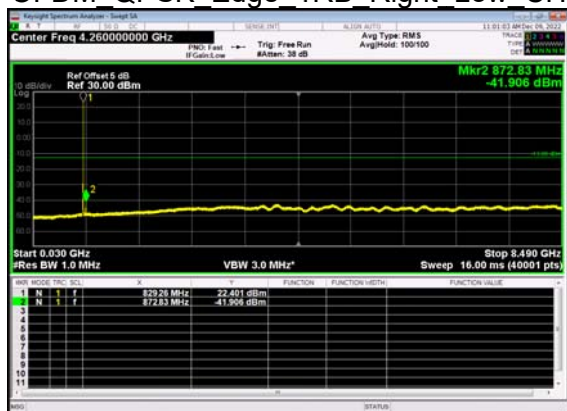
N5(5M)_DFT-s- OFDM QPSK Edge 1RB Right Low CH
