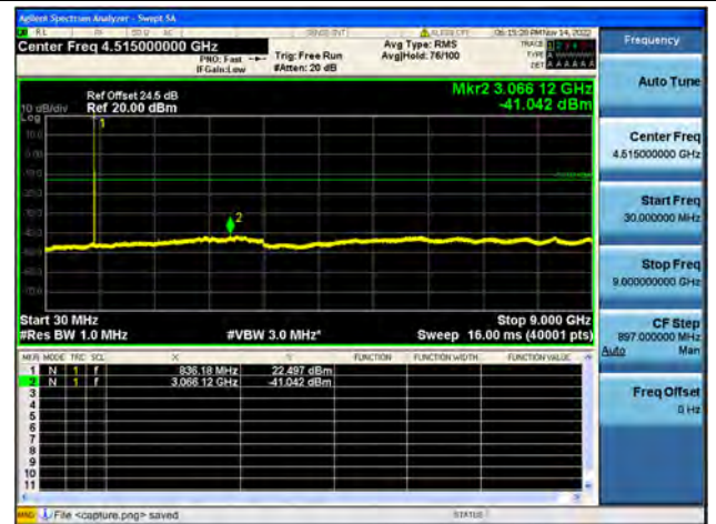
Band5 / 1.4MHz / Mid CH / QPSK
