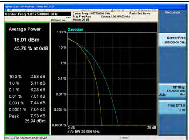
Band2 / 15MHz / Low CH / 16QAM
