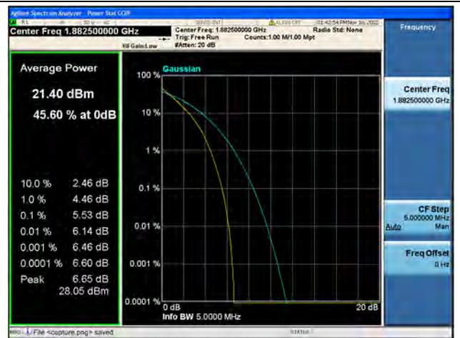
Band25 / 5MHz / Mid CH / QPSK
