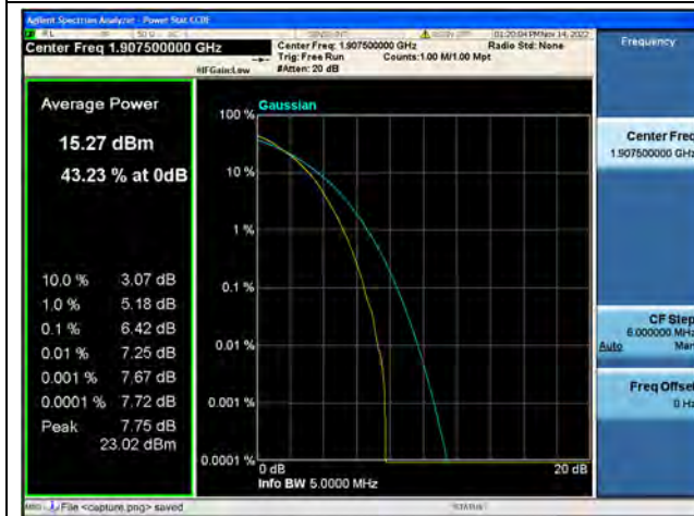
Band2 / 5MHz / High CH / 64QAM
