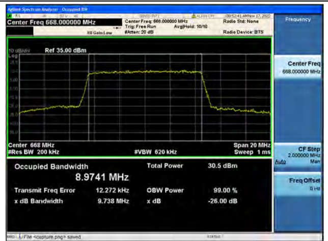
Band71 / 10MHz / QPSK/ Low CH
