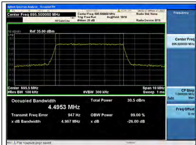
Band71 / 5MHz / QPSK/ High CH
