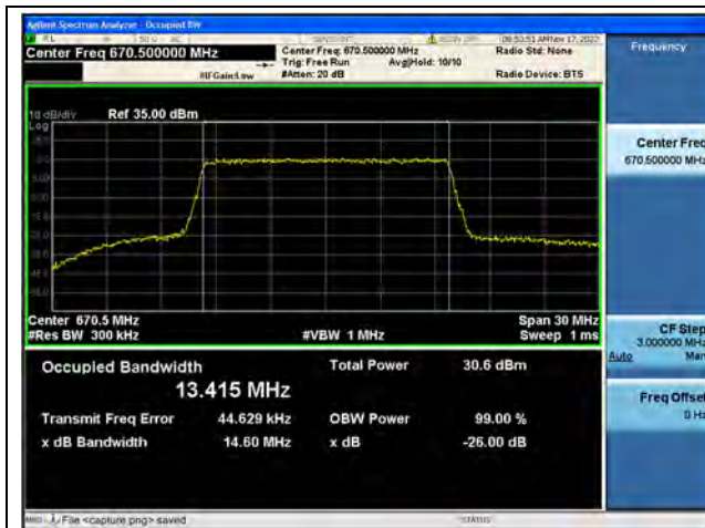
Band71 / 15MHz / QPSK/ Low CH
