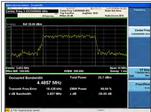
Band42 / 5MHz / QPSK/ Low CH
