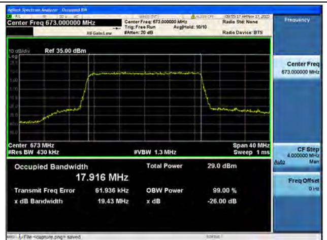
Band71 / 20MHz / 64QAM/ Low CH
