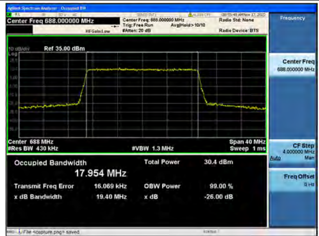
Band71 / 20MHz / QPSK/ High CH
