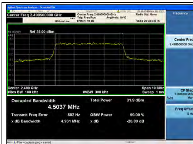
Band41 / 5MHz / QPSK/ Low CH
