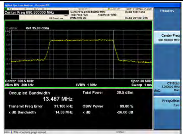
Band71 / 15MHz / QPSK/ Mid CH
