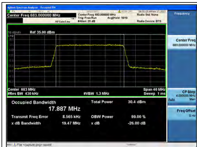
Band71 / 20MHz / QPSK/ Mid CH
