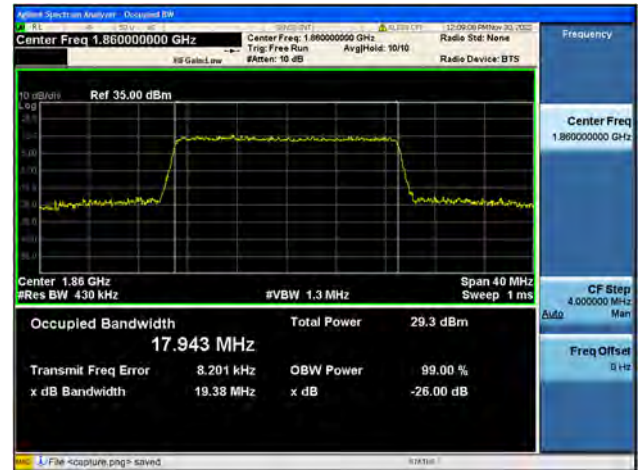
Band25 / 20MHz / QPSK/ Low CH
