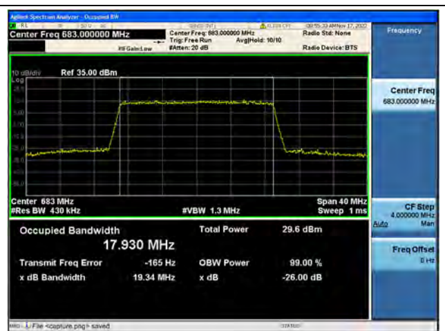
Band71 / 20MHz / 16QAM/ Mid CH
