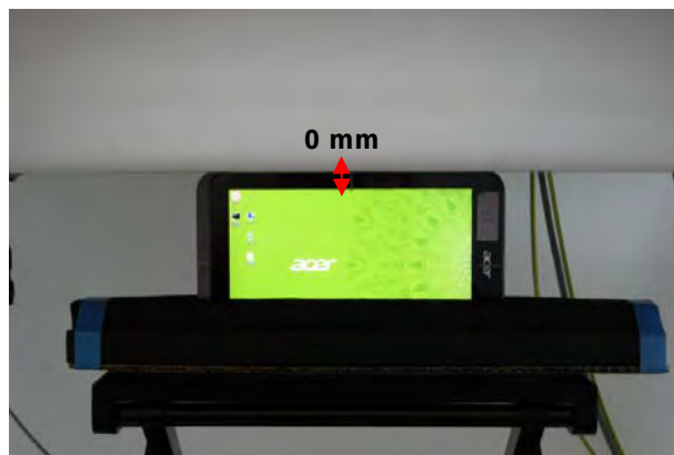
Fig.5 EUT Left Edge to flat phantom
