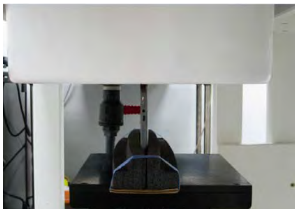
Fig.6 EUT Right Edge to flat phantom
