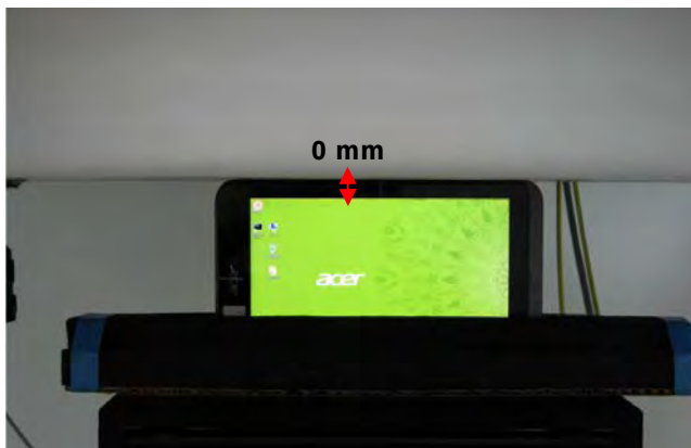
Fig.6 EUT Right Edge to flat phantom
