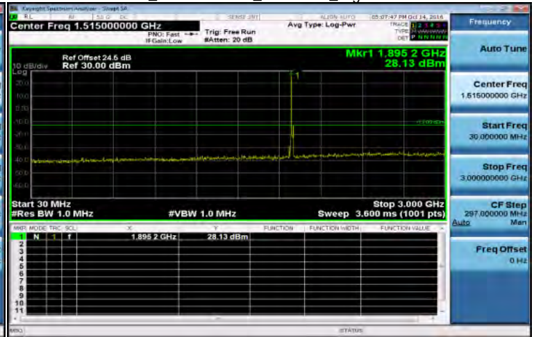
30MHz~3GHz_Band2 15MHz_QPSK 1 0_HighCH19125-1902.5
