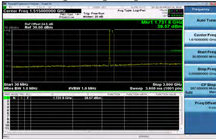
30MHz~3GHz_Band4 5MHz_QPSK 1 0_MidCH20175-1732.5
