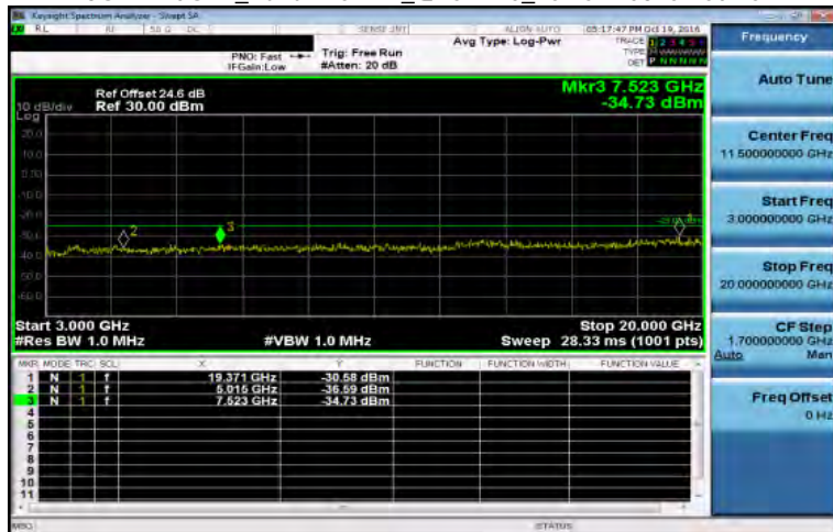
3GHz~10GHz_Band7 15MHz_QPSK 1 0_LowCH20825-2507.5
