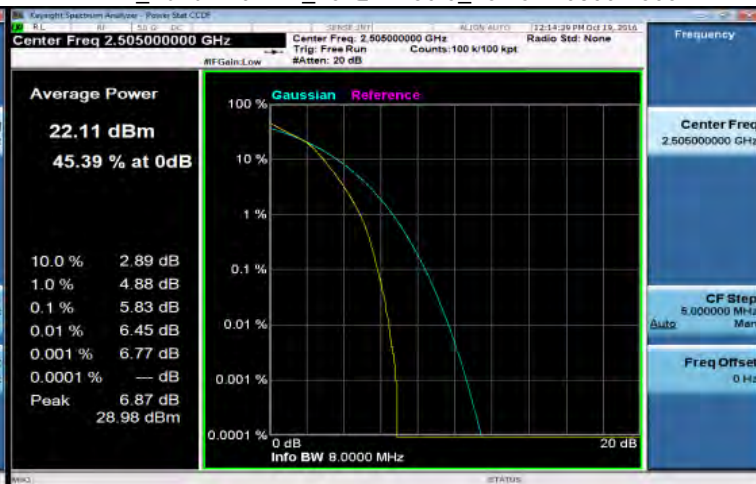
LTE_Band7 10MHz_16-QAM 50 0_MidCH21100-2535
