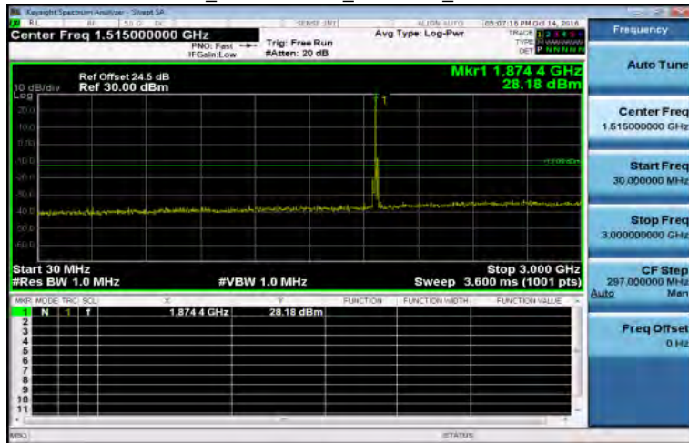
30MHz~3GHz_Band2 15MHz_QPSK 1 0_MidCH18900-1880
