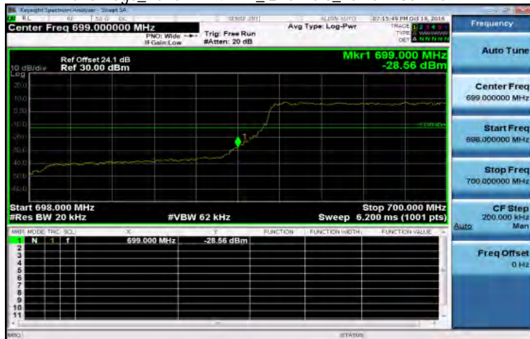
Band Edge_Band12 1.4MHz_QPSK 6 0_LowCH23017-699.7
