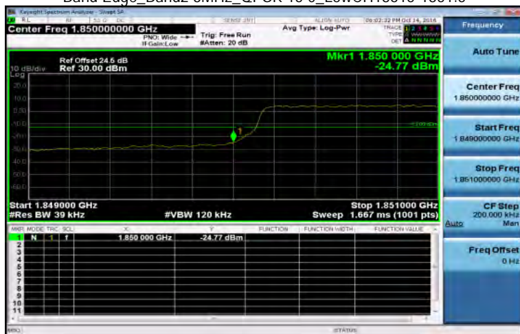
Band Edge_Band2 3MHz_QPSK 15 0_LowCH18615-1851.5
