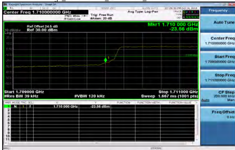
Band Edge_Band4 3MHz_QPSK 15 0_LowCH19965-1711.5
