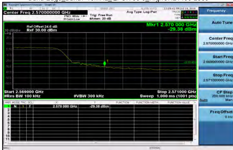
Band Edge_Band7 10MHz_QPSK 50 0_HighCH21400-2565
