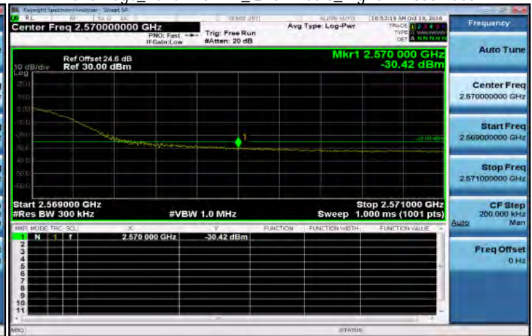
Band Edge_Band7 20MHz_QPSK 100 0_HighCH21350-2560
