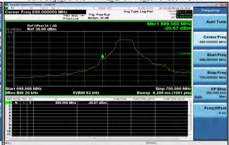
Band Edge_Band12 1.4MHz_QPSK 1 0_LowCH23017-699.7
