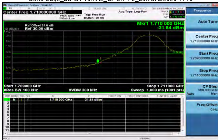
Band Edge_Band4 10MHz_QPSK 1 0_LowCH20000-1715
