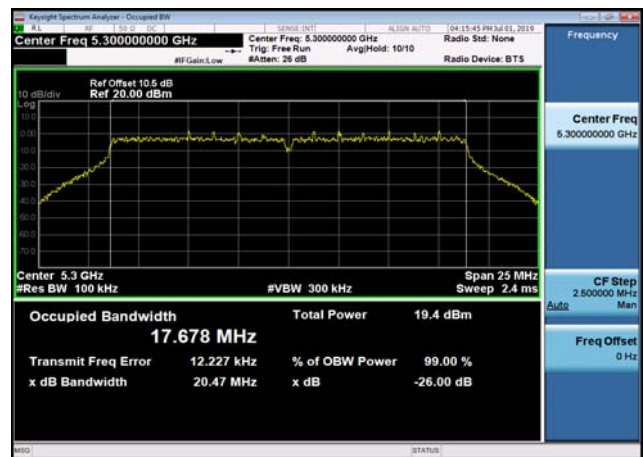
U-NII-2a 26dB Bandwidth-802.11ac(40MHz z) ,5270MHz,Ant1
