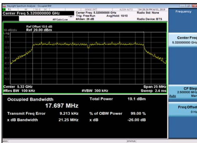
U-NII-2a 26dB Bandwidth-802.11ac(20MHz z) ,5320MHz,Ant1
