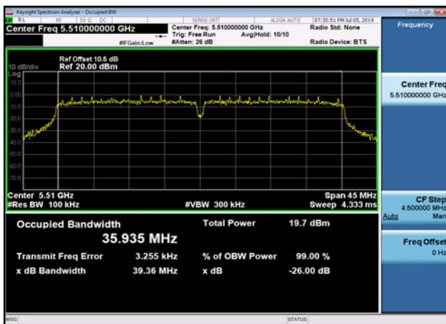
U-NII-2c 26dB Bandwidth-802.11ac(40MHz),5670MHz,Ant1
