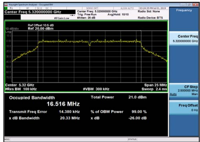
U-NII-2a 26dB Bandwidth-802.11ac(20MHz z) ,5300MHz,Ant1
