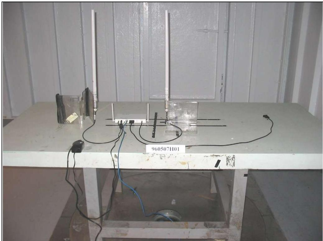
RADIATED EMISSION TEST (2.4GHz Antenna: FDS\_2FED01+I3G / FDS\_2FED02+I3G)
