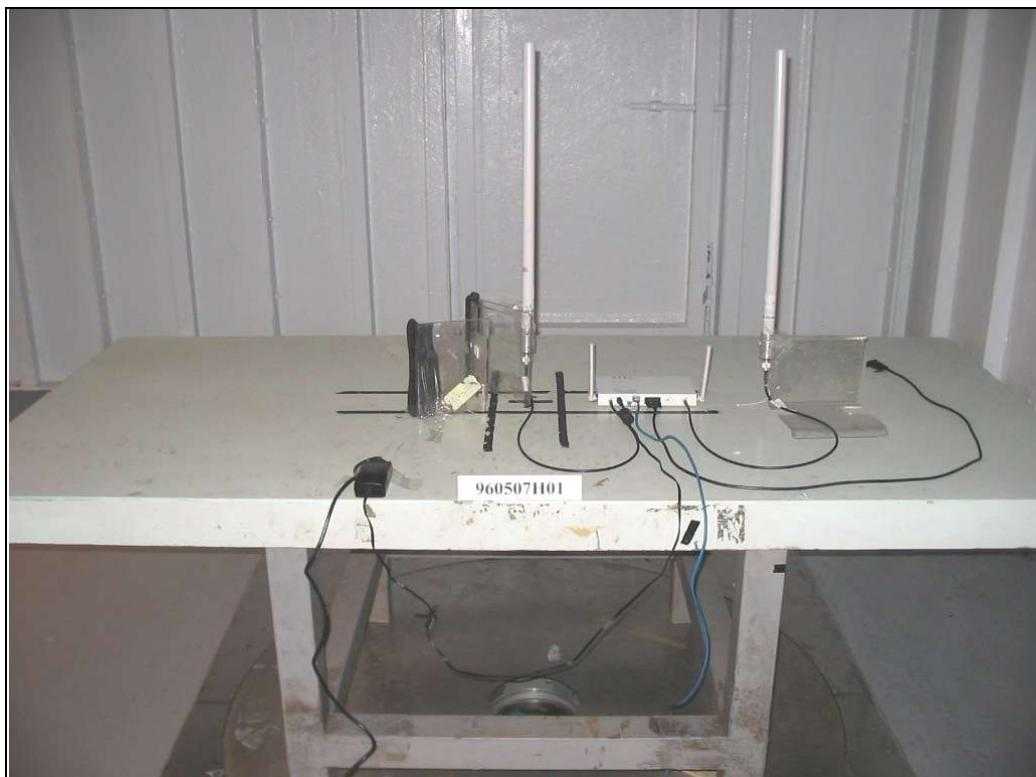
RADIATED EMISSION TEST (5GHz Antenna: FDS\_2FED01+I3G / FDS\_2FED02+I3G)
