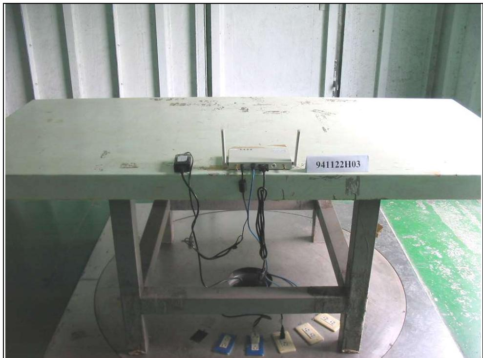
RADIATED EMISSION TEST (ANTENNA: FDS\_2FED01+I3G + POE)
