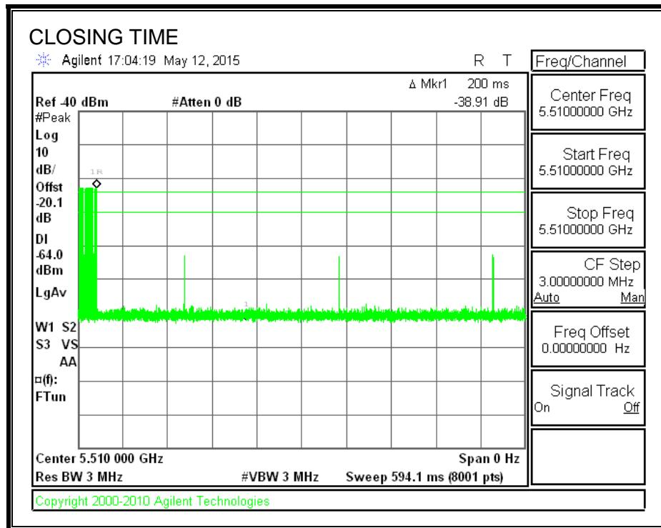
**AGGREGATE CHANNEL CLOSING TRANSMISSION TIME**
