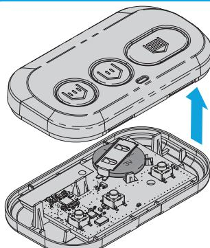
**NOTA:** La tarjeta lógica podría desprenderse de la parte inferior del control remoto. Si esto ocurre, vuelva a colocarla con cuidado a partir de los orificios guía de la tarjeta.
