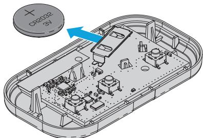
**04** Inserte la batería de repuesto con el polo positivo hacia arriba.
