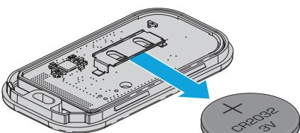
Siguiendo la dirección de la flecha "INSERT" (INSERTAR) impresa en la tarjeta lógica, inserte la batería de repuesto con el polo positivo hacia arriba.
