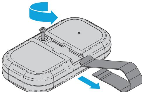
**02** Con los botones hacia arriba, haga palanca para separar la carcasa superior de la inferior (si la carcasa no se separa, verifique que el tornillo cautivo gire libremente).
