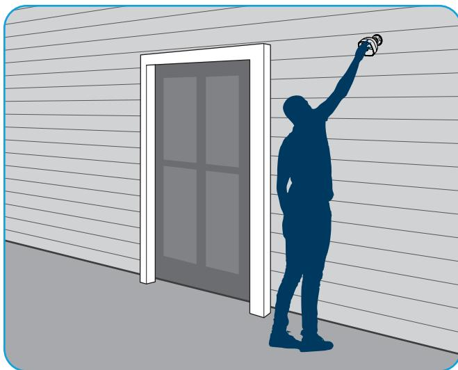
Sostenga la placa de montaje en la ubicación donde desee colocar la cámara. Marque los orificios izquierdos y derechos con un lápiz.
