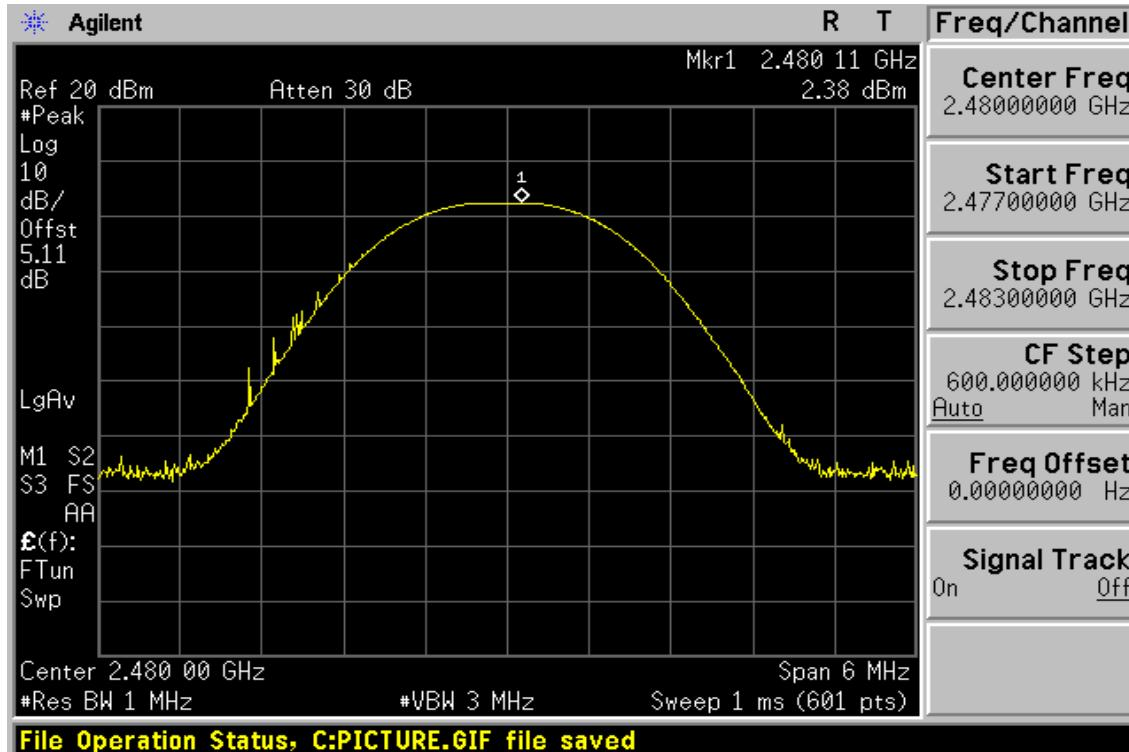
Peak Power Output Data Plot (CH Low) (EDR mode  $\pi/4$ DQPSK)
