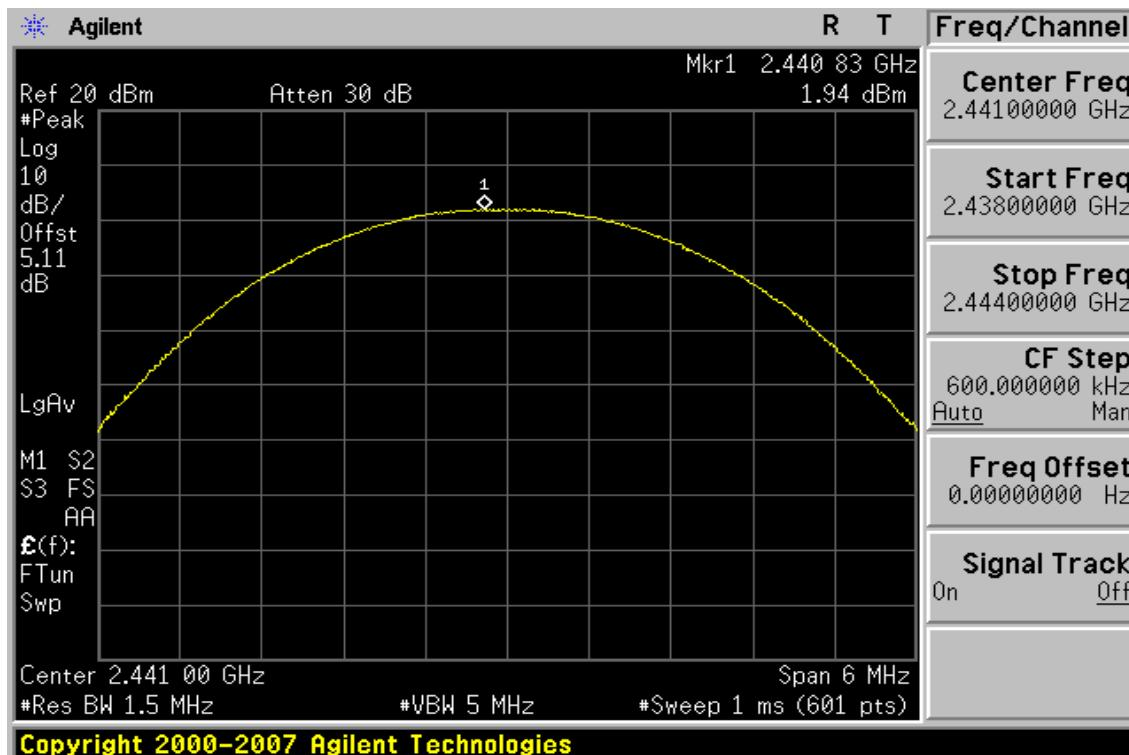
Peak Power Output Data Plot (CH High) (EDR mode  $\pi/4$ DQPSK)
