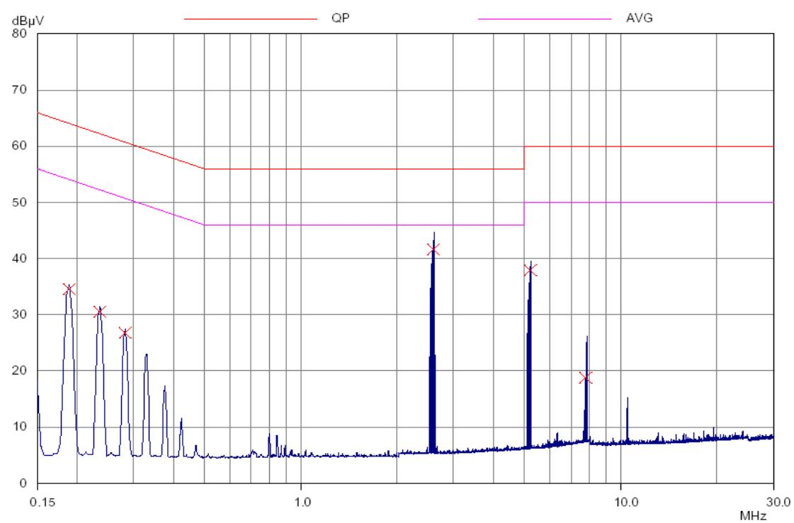
**C. Charger 3**Operation Mode : Handset Charging NeutralTest Date : Jun. 02, 2008 Temperature : 23 °C Humidity : 66 %
