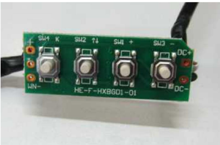
3c) Switch (Switch board front)
