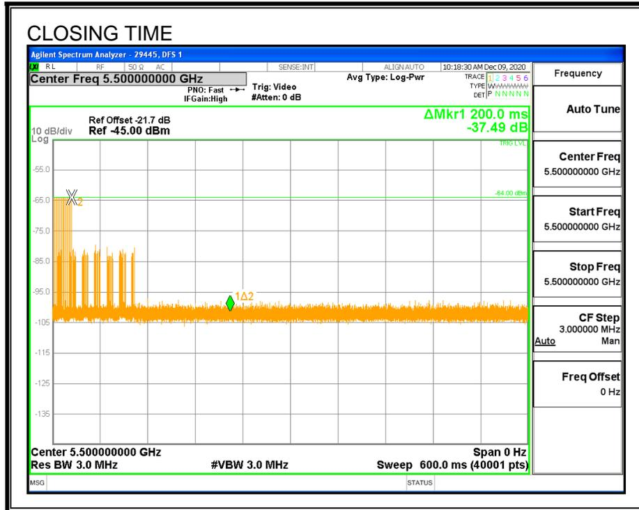
**AGGREGATE CHANNEL CLOSING TRANSMISSION TIME**
