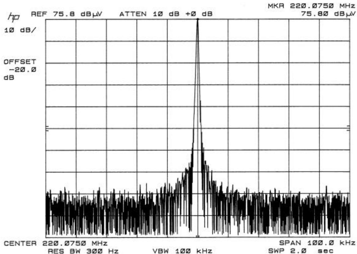
OCCUPIED BANDWIDTH PLOT - 9600 BAUD
