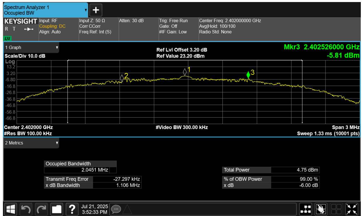
-6dB Bandwidth NVNT BLE 2442MHz Ant1
