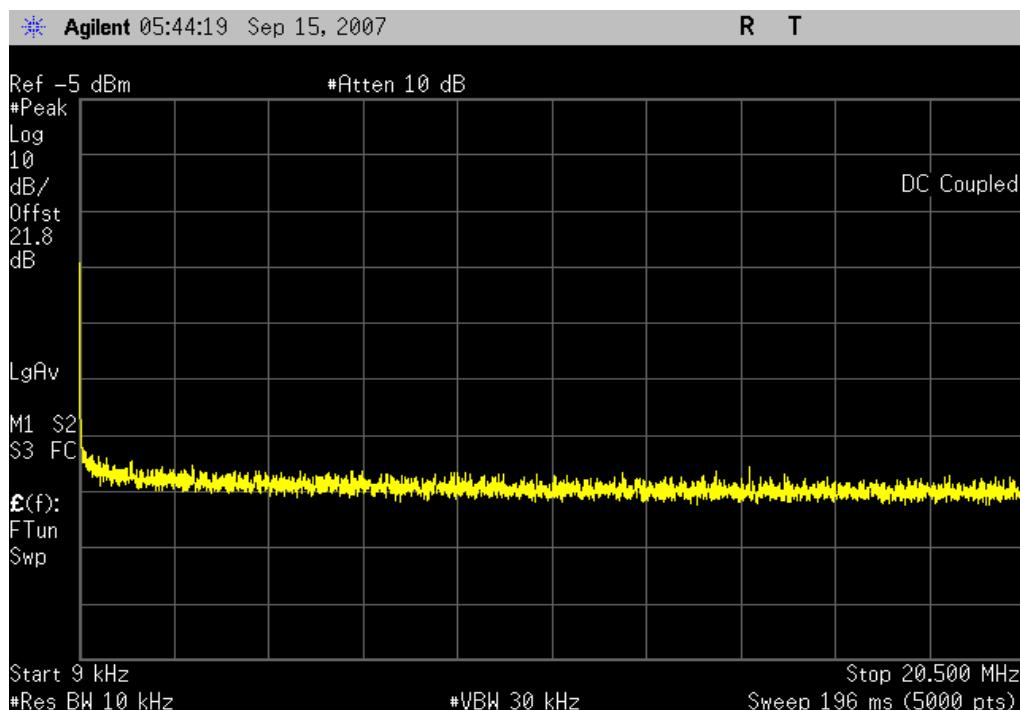
Bluetooth, pi/4-DQPSK, 2DH5, Mid channel, 2441MHz, 20 MHz - 3.1 GHz
