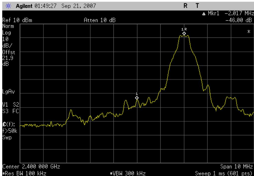
Bluetooth, GFSK, DH5, High channel, 2480MHz
