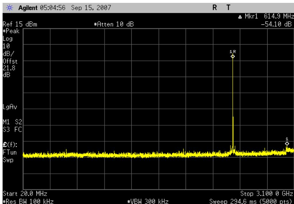
Bluetooth, pi/4-DQPSK, 2DH5, Low channel, 2402MHz, 3 GHz - 6.6 GHz
