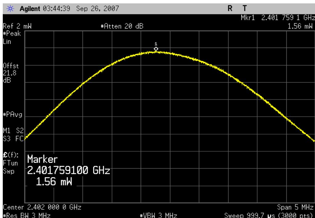
Bluetooth, pi/4 - DQPSK, 2DH5, Mid channel, 2441MHz
