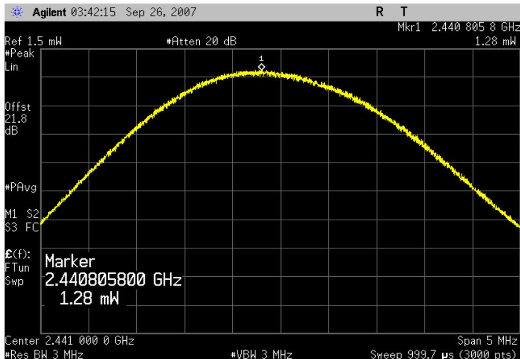
Bluetooth, pi/4 - DQPSK, 2DH5, High channel, 2480MHz
