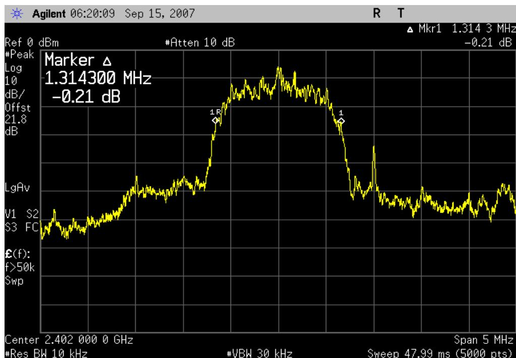
20 dB Bandwidth, Bluetooth, pi/4 - DQPSK, 2DH5, Mid channel, 2441MHz
