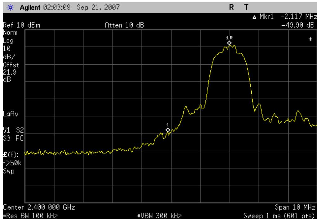
Bluetooth, pi/4-DQPSK, 2DH5, High channel, 2480MHz
