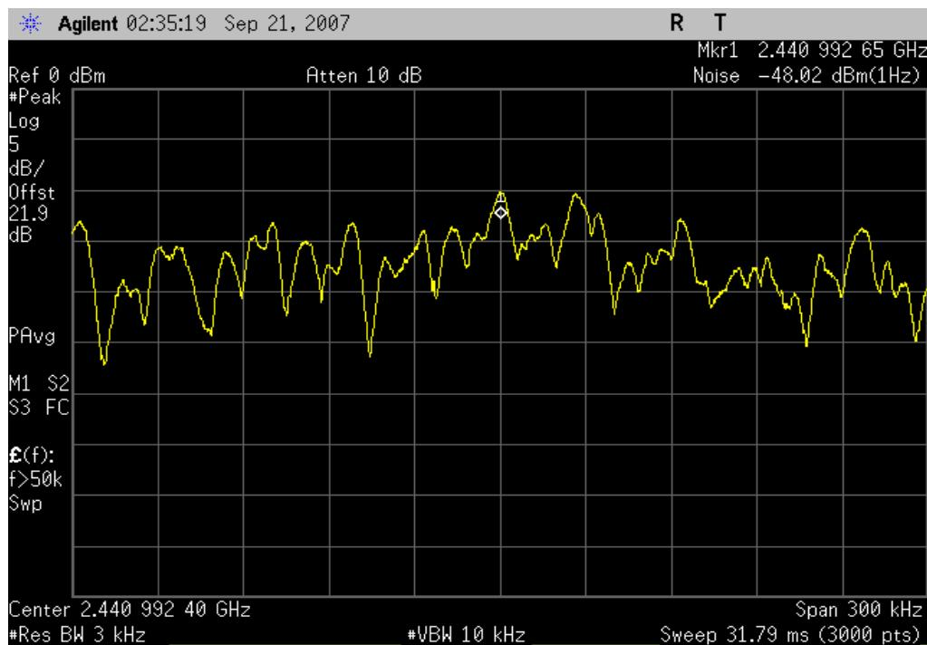
Bluetooth, GFSK, DH5, High channel, 2480MHz
