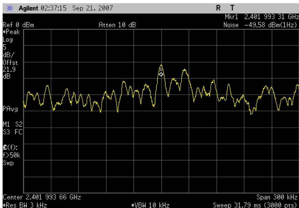
Bluetooth, pi/4 -DQPSK, 2DH5, Mid channel, 2441MHz
