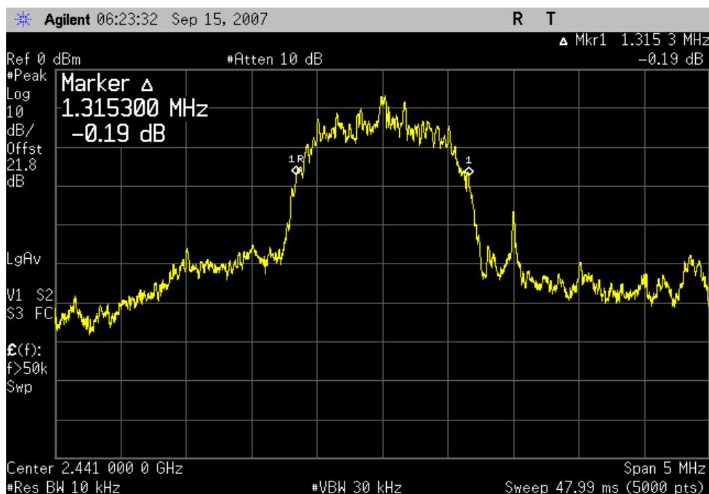
20 dB Bandwidth, Bluetooth, pi/4 - DQPSK, 2DH5, High channel, 2480MHz
