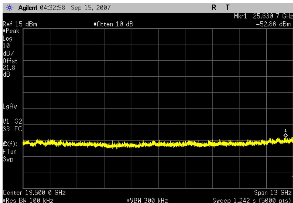
Bluetooth, GFSK, DH5, Mid channel, 2441MHz, 9 kHz - 20.5 MHz
