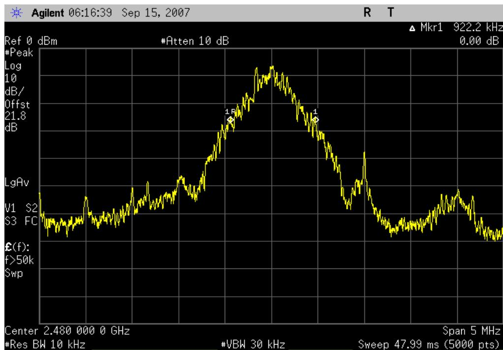
20 dB Bandwidth, Bluetooth, pi/4 - DQPSK, 2DH5, Low channel, 2402MHz
