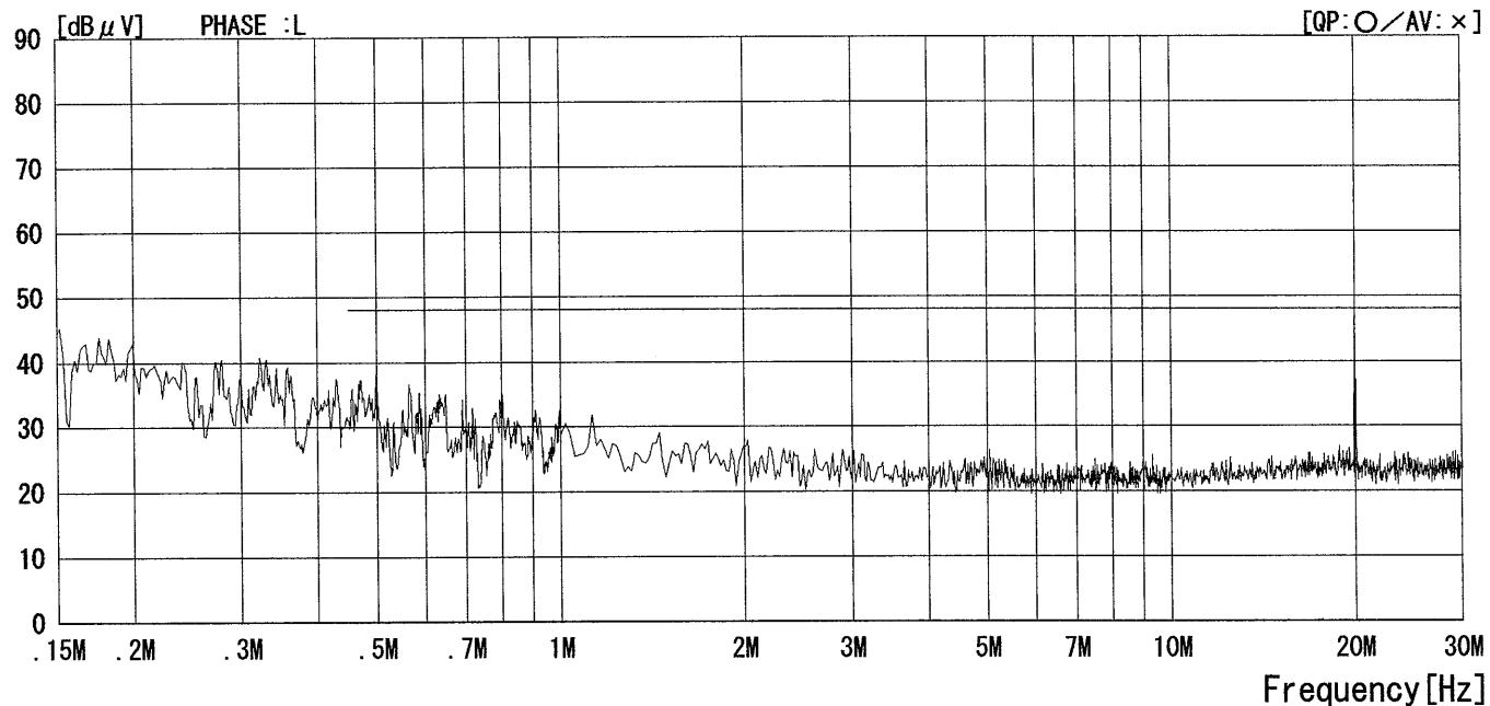
CHART : WITHOUT FACTOR , CALCURATION : RESULT=READING+C. F (LISN LOSS+CABLE LOSS)
