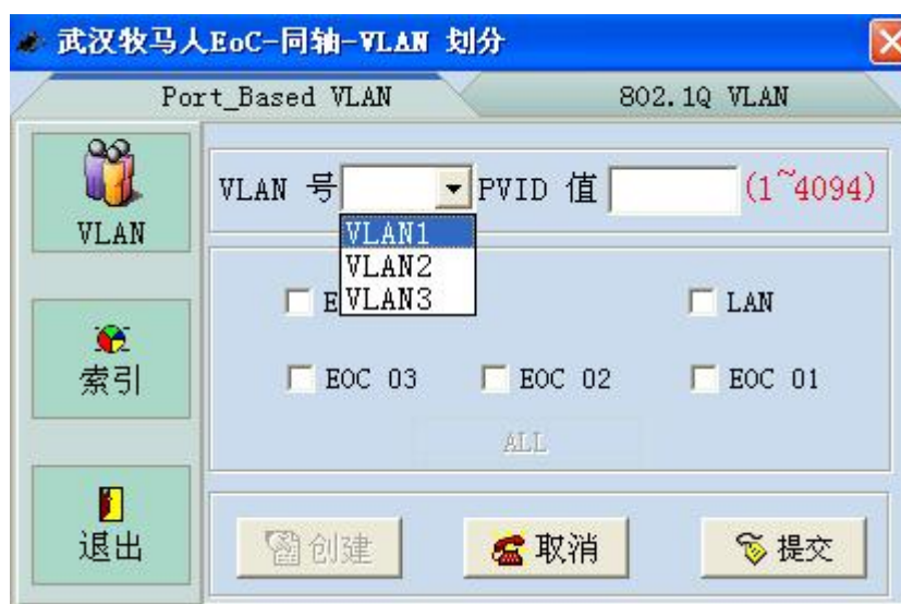
图 18 配置 Port-Based VLAN
