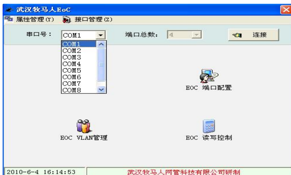
图 7: 选择串口号并单击“连接设备”
