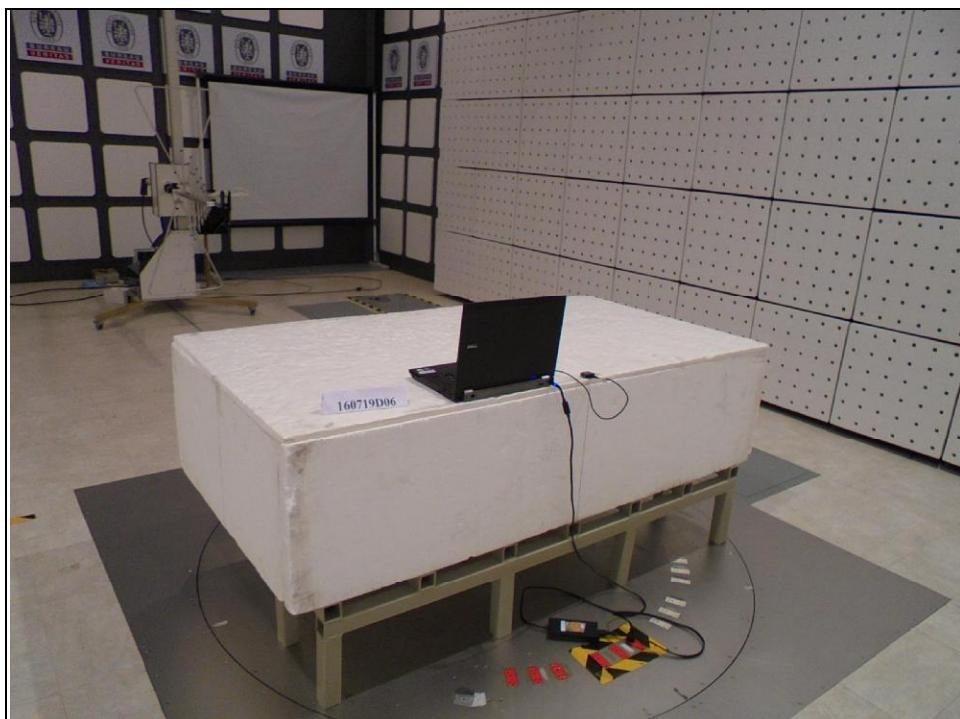
RADIATED EMISSION TEST- Mode A
