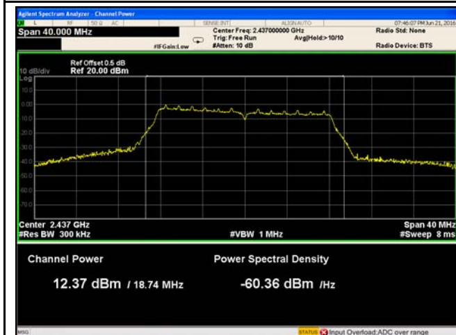
802.11g - AV Output power - Mid CH 2437
