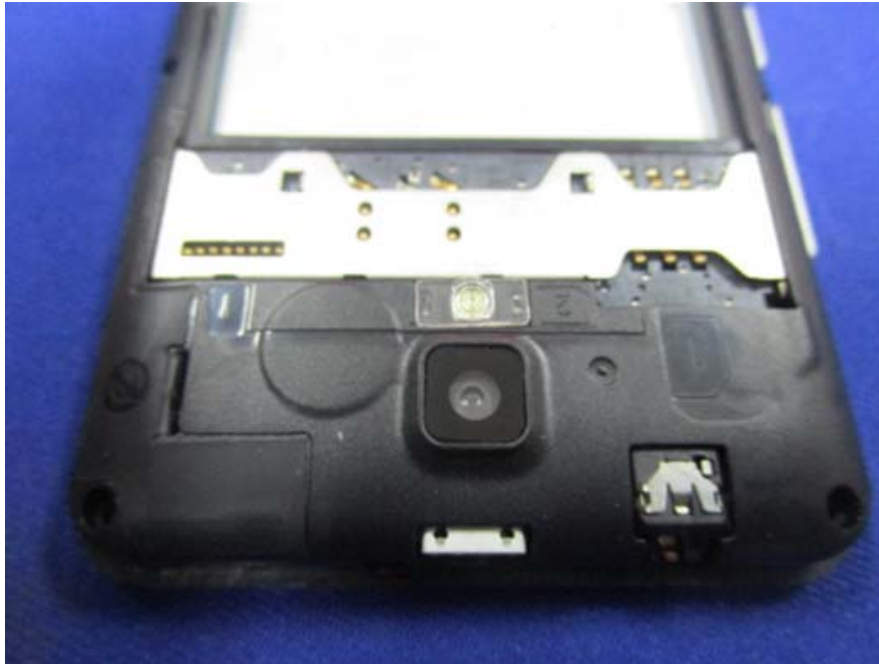
EUT –Wifi&BT Antenna View
