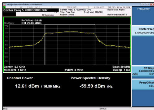
U-NII-2c Output Power-802.11ac(20MHz) ,5580MHz,Ant1
