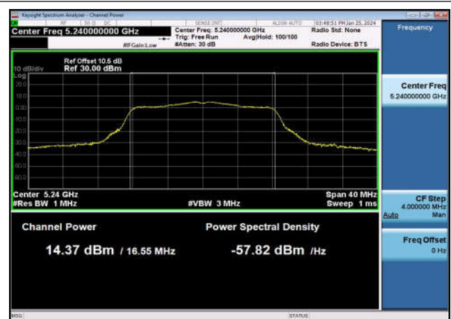
U-NII-1 Output Power-802.11ac(20MHz) ,5220MHz,Ant1
