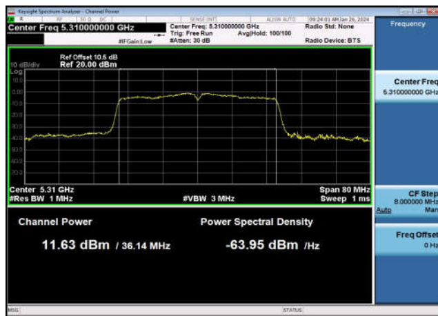
U-NII-2a Output Power-802.11a(20MHz) ,5300MHz,Ant1
