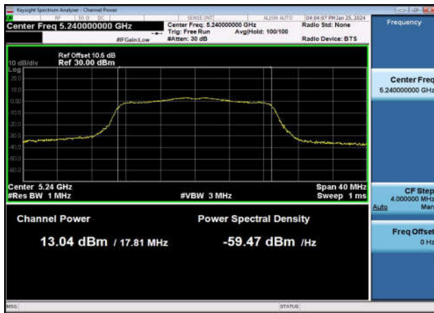
U-NII-1 Output Power-802.11n(40MHz) ,5230MHz,Ant1
