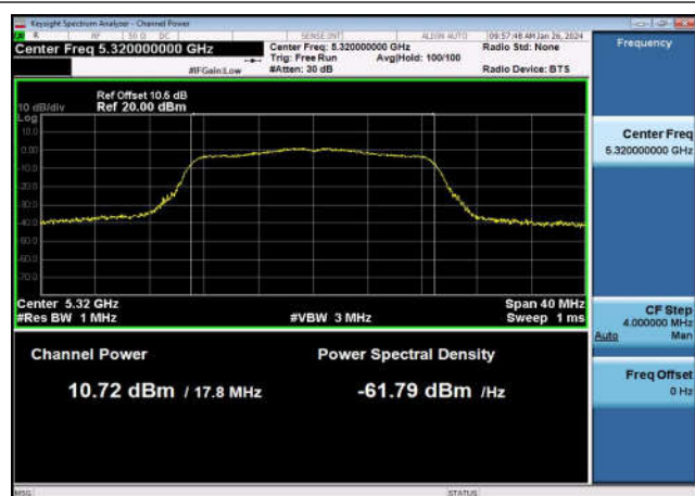
U-NII-2a Output Power-802.11ac(40MHz) ,5310MHz,Ant1
