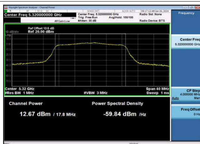
U-NII-2a Output Power-802.11n(20MHz) ,5320MHz,Ant1
