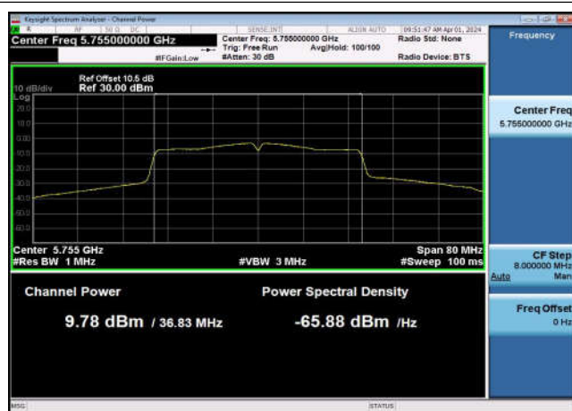
U-NII-3 Output Power-802.11n(40MHz) ,5755MHz,Ant1
