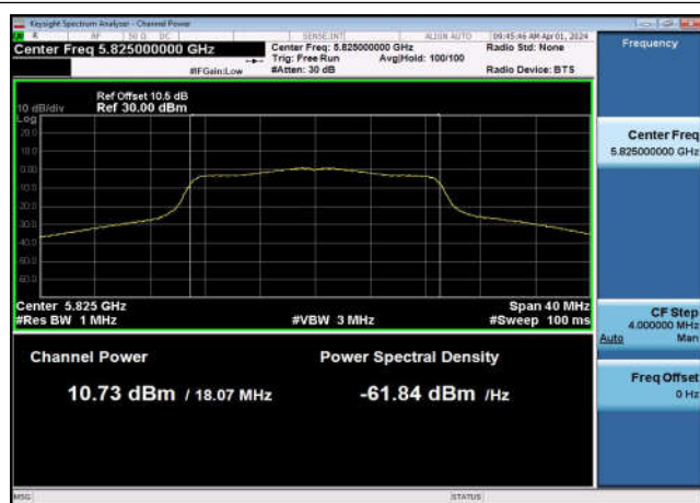
U-NII-3 Output Power-802.11n(20MHz) ,5825MHz,Ant1
