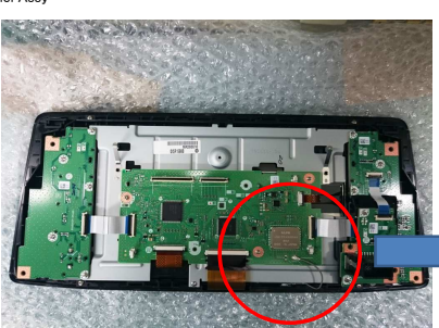
【BT/WiFi ANT , BT/WiFi module mounting position】
