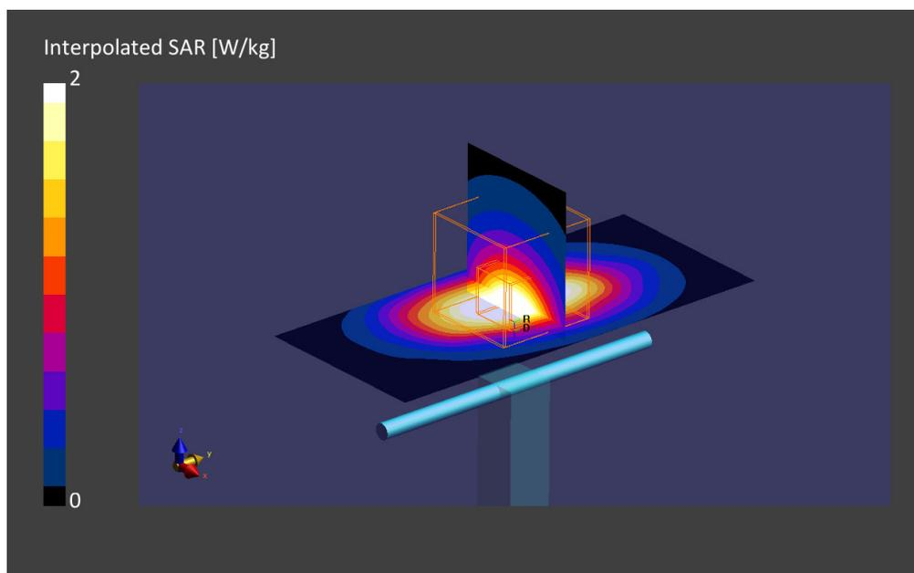
**18. System Check Body Liquid 2300MHz**
