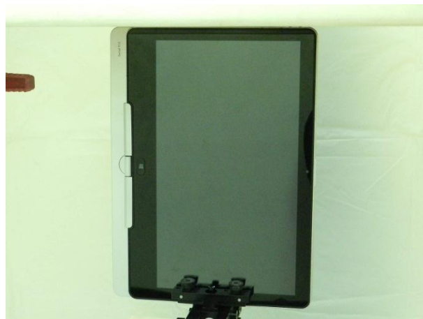
Edge 4 with Phantom 0 cm Gap
