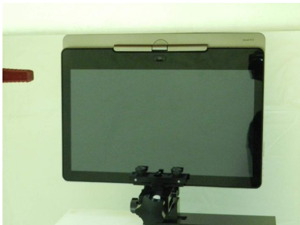
Edge 3 with Phantom 0 cm Gap
