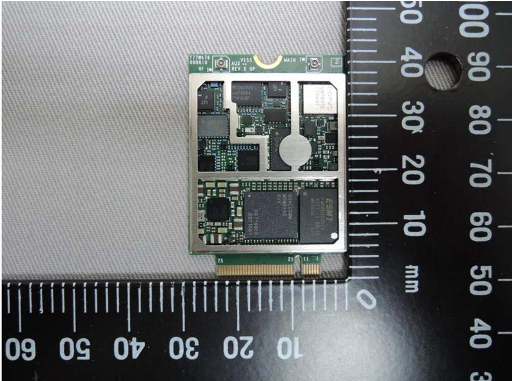
**WLAN / BT Module - 1 (Model No.: 8265D2W)**
