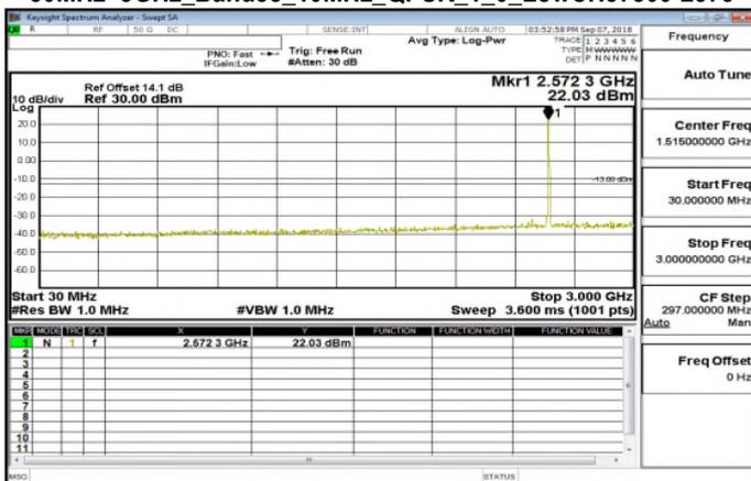
3GHz~10GHz Band38 10MHz QPSK 1 0 MidCH38000-2595
