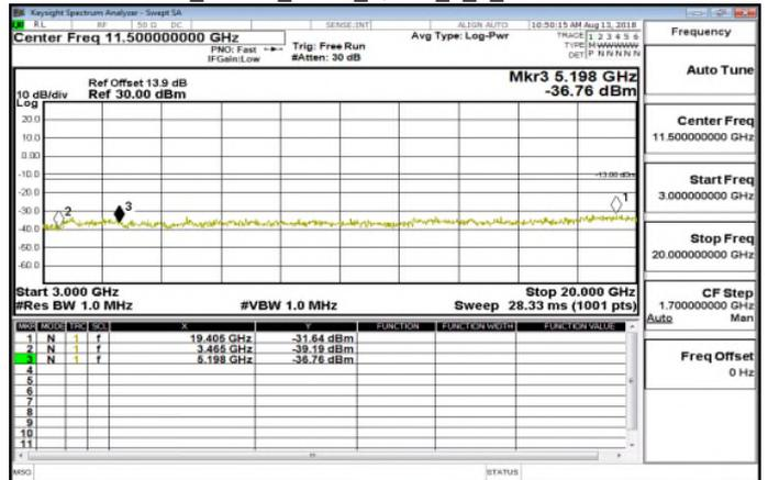
3GHz~10GHz Band4 5MHz QPSK 1 0 LowCH19975-1712.5
