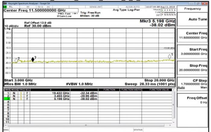
3GHz~10GHz Band4 20MHz QPSK 1 0 LowCH20050-1720
