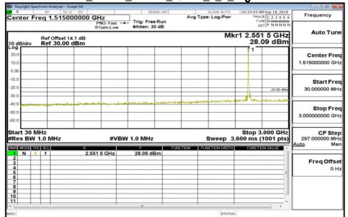
30MHz~3GHz Band7 20MHz QPSK 1 0 MidCH21100-2535
