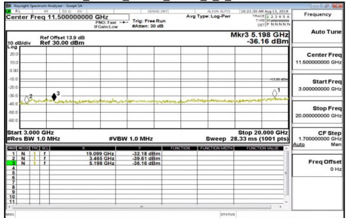
3GHz~10GHz Band4 15MHz QPSK 1 0 LowCH20025-1717.5
