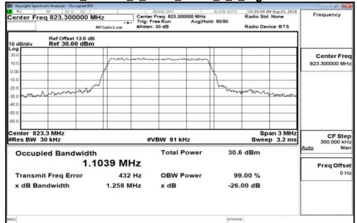
**Part 90 Band26 1 4MHz QPSK 6\_0 LowCH26697**
