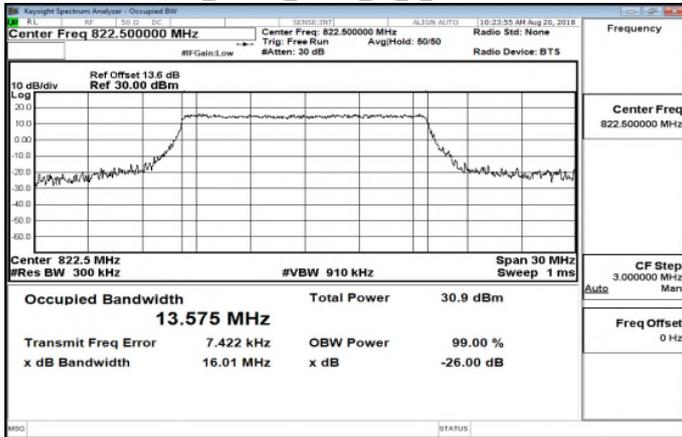
**Band26 15MHz 16QAM 75\_0 LowCH26775**
