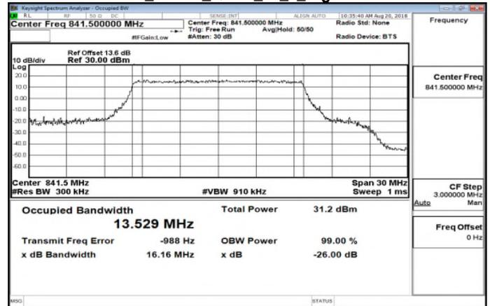
**Band26 15MHz QPSK 75\_0 LowCH26775**
