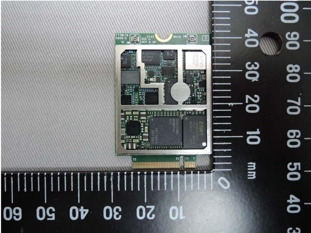
**WLAN / BT Module (Model No.: 8265D2W)**
