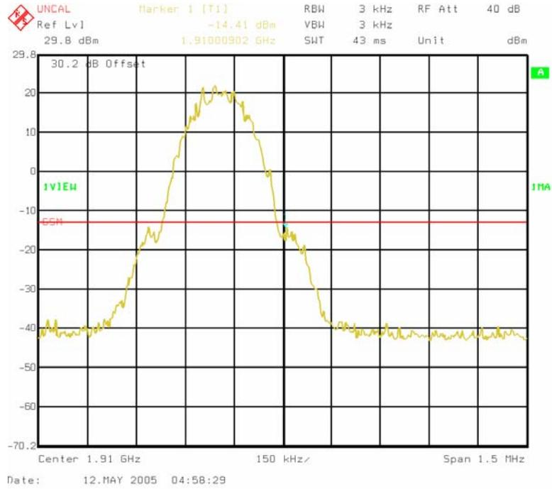
Figure 6-4. GSM/PCS 1900 Ch 810 Upper Band Edge
