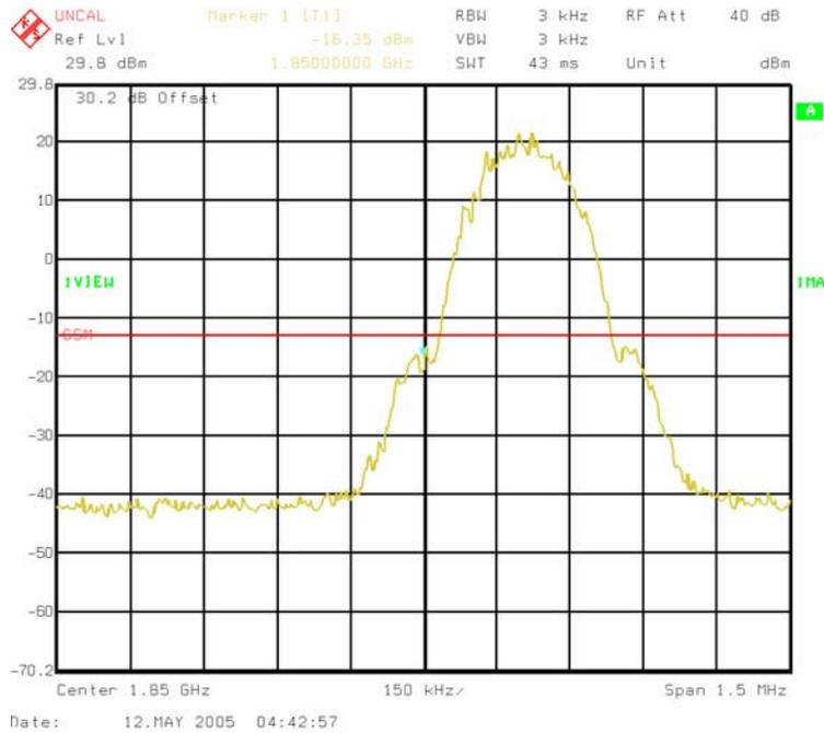
Figure 6-3. GSM/PCS 1900 Ch 512 Lower Band Edge
