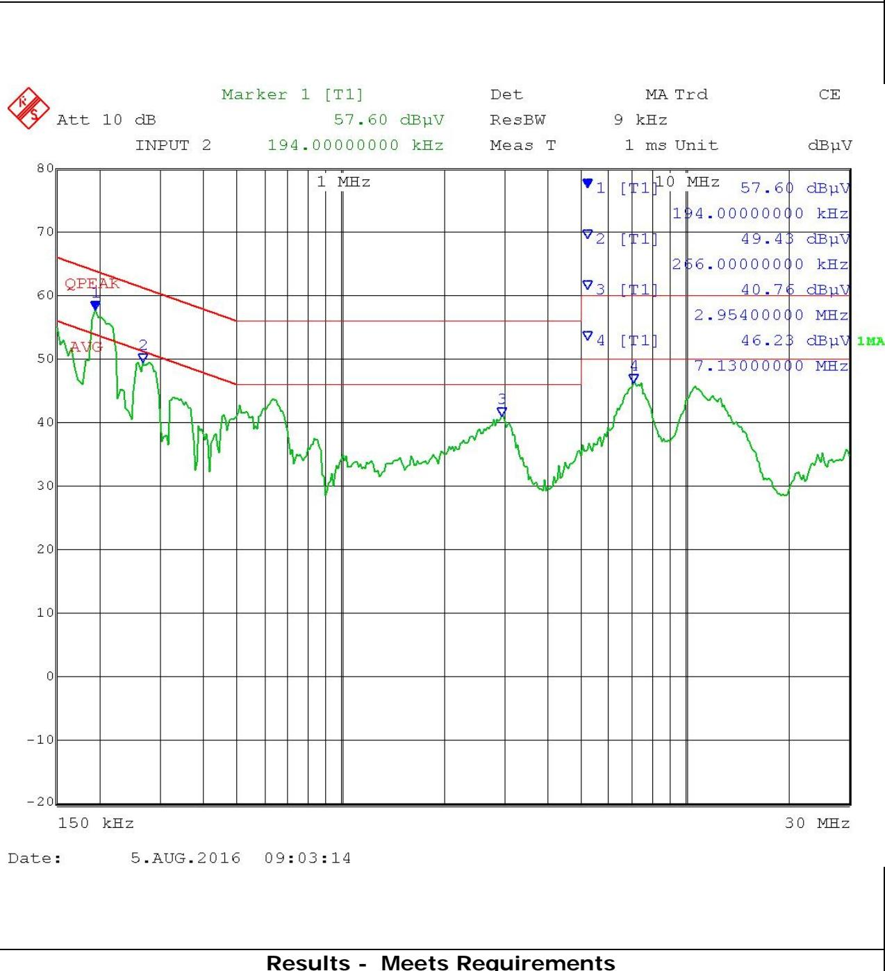
**POWER LINE CONDUCTED INTERFERENCE**
