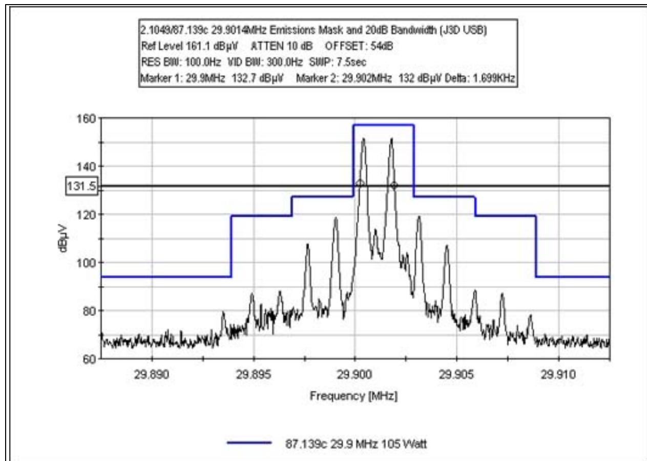
**EMISSIONS MASK AND OCCUPIED BANDWIDTH - J2D/J3D LSB 2.1 MHz**
