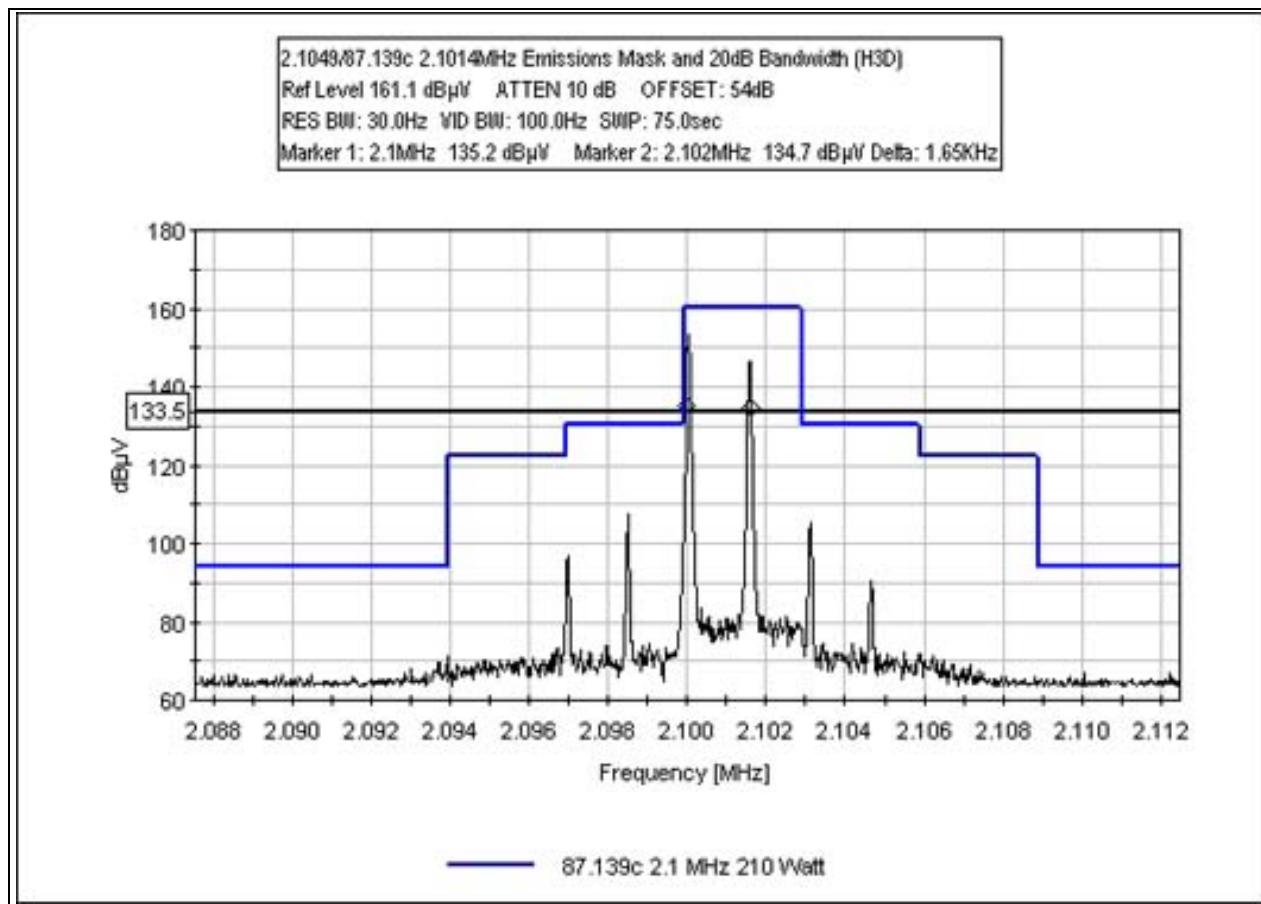
**EMISSIONS MASK AND OCCUPIED BANDWIDTH - H2D/H3D USB 10.1 MHz**
