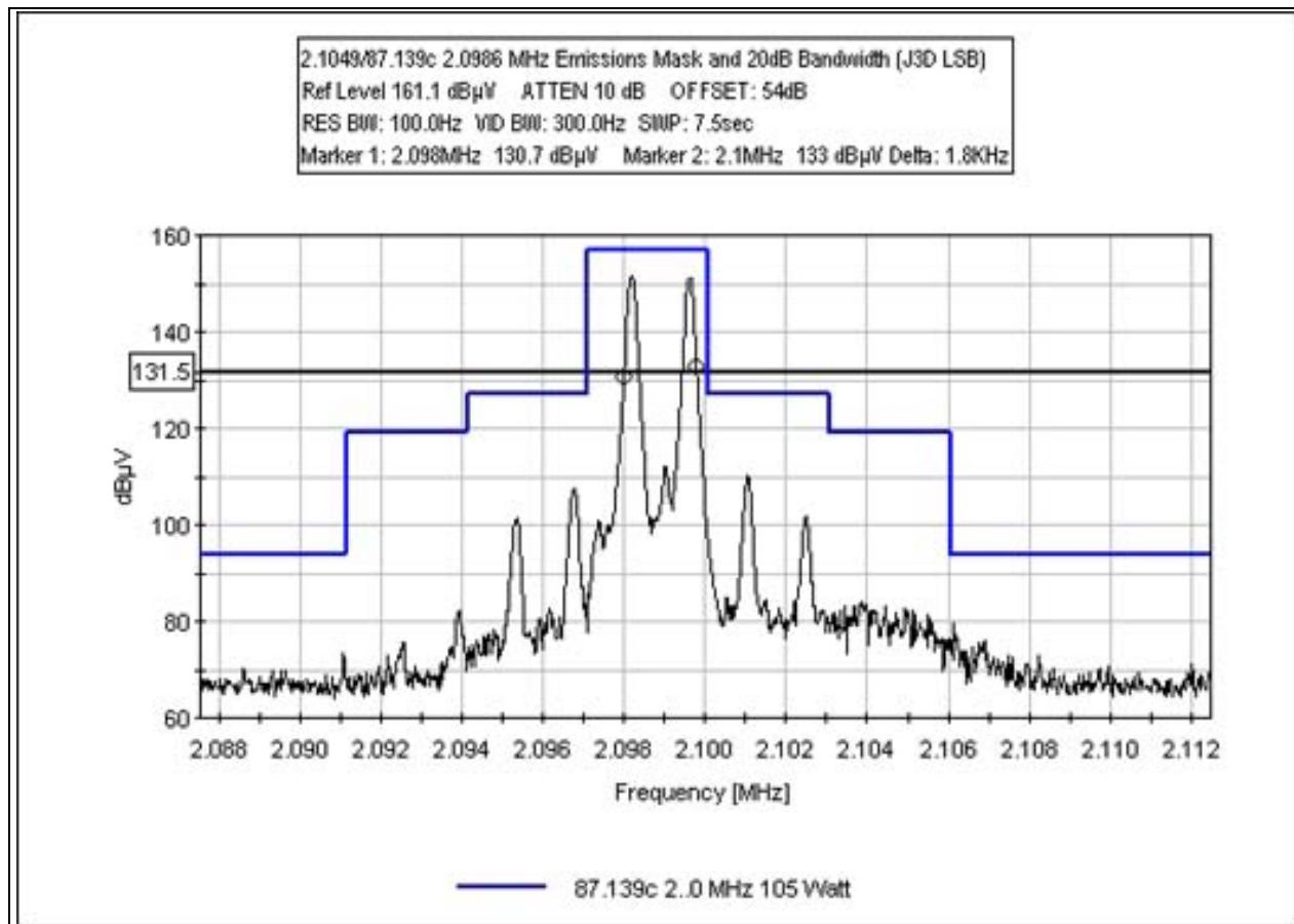
**EMISSIONS MASK AND OCCUPIED BANDWIDTH - J2D/J3D LSB 10.1 MHz**
