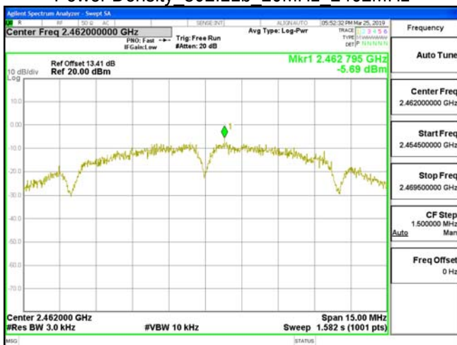
Power Density 802.11b 20MHz 2462MHz
