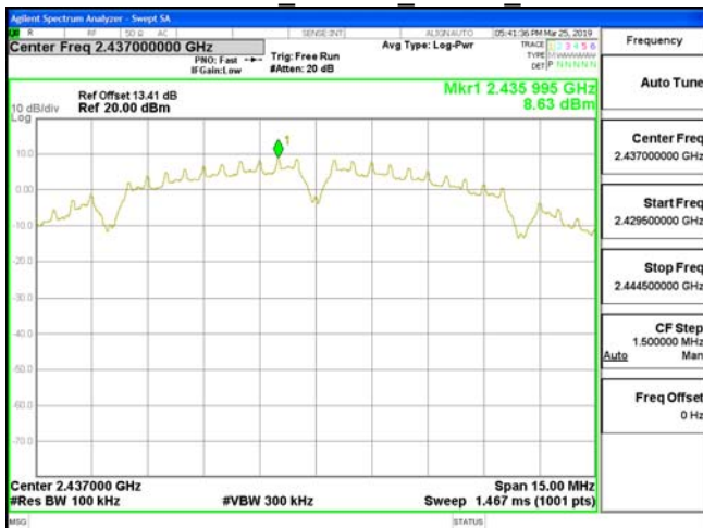
Reference Level 802.11b 20MHz 2462MHz
