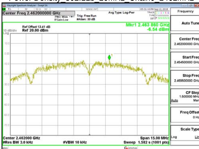
Power Density 802.11b 20MHz Chain0 2462MHz
