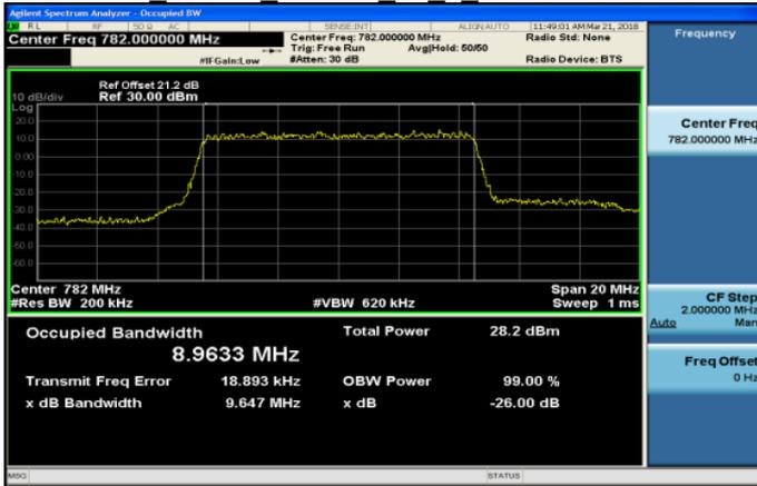
Band13 10MHz 64QAM 50 0 LowCH23230-782
