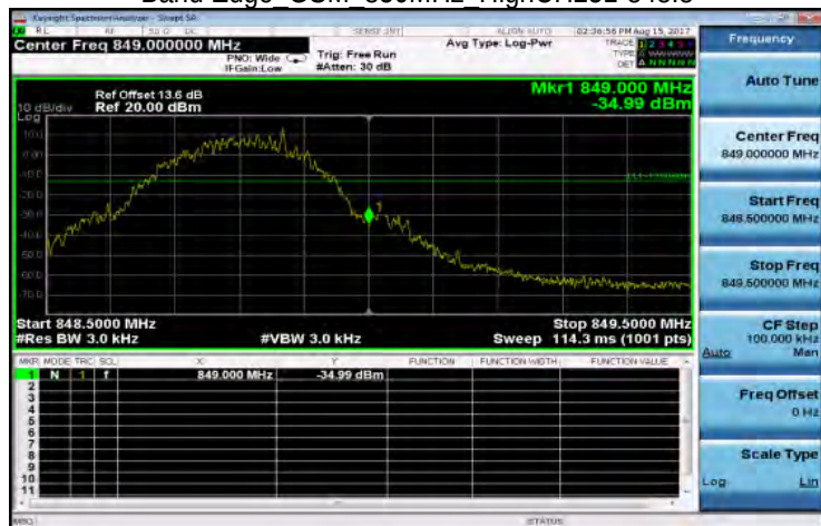
Band Edge GSM 850MHz HighCH251-848.8
