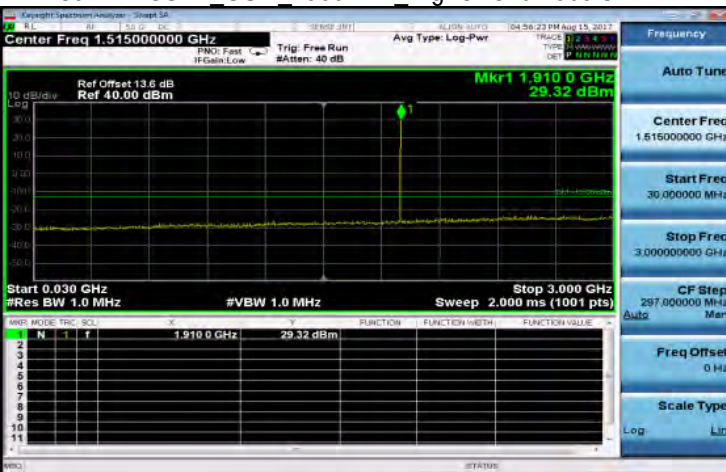
30MHz~3GHz GSM 1900MHz HighCH810-1909.8
