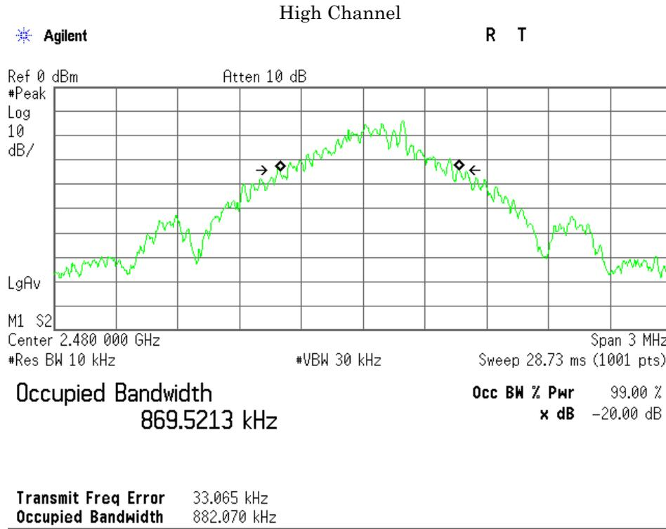
2) Packet Setting : 2DH5 (Modulation type : pi/4-DQPSK)
