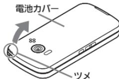
●ツメに指をかけ、電池カバーと本体との間にすきまを作るようにして、ツメの左右を少し浮かせます。
