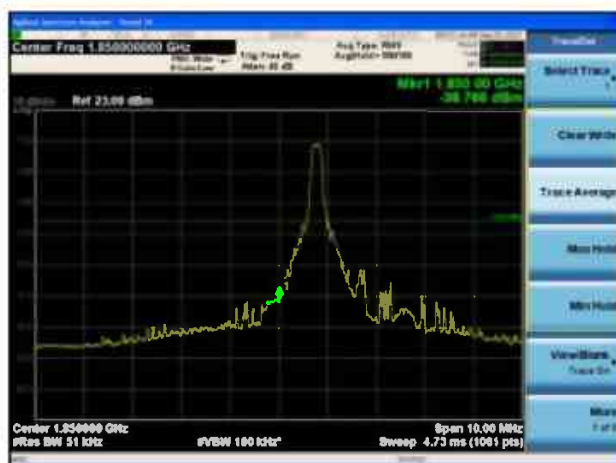
LTE Band 2 10MHz QPSK 1RB CH-Low
