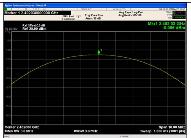
\pi/4 DQPSK Output power - Low CH 2402
