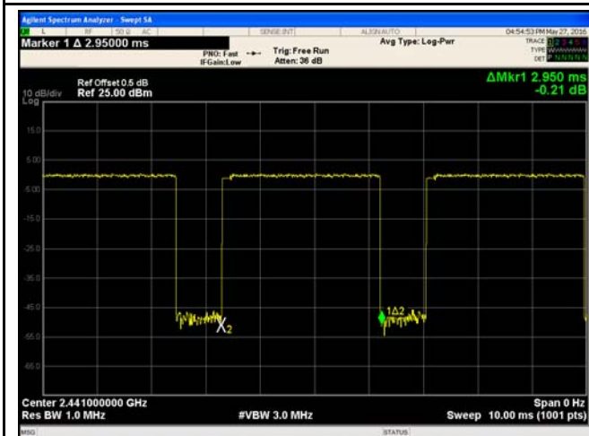
\pi/4 DQPSK - Mid CH 2441
