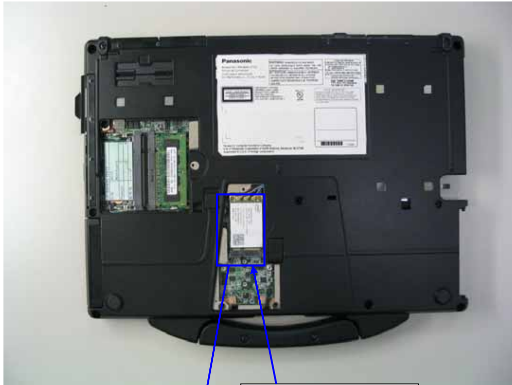
WLAN module position
